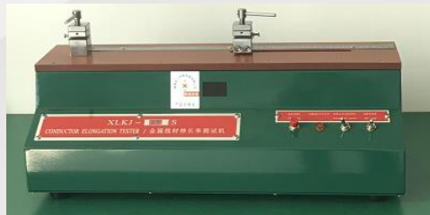
铜线延伸率测试机 Elongation tester
